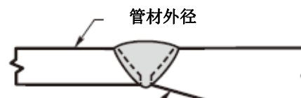
(C) 用斜形焊缝过渡
