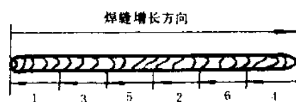
图 25 各分段焊接方向
