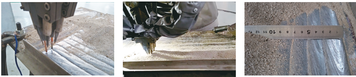
图8 焊接工艺评定时堆焊成型情况
