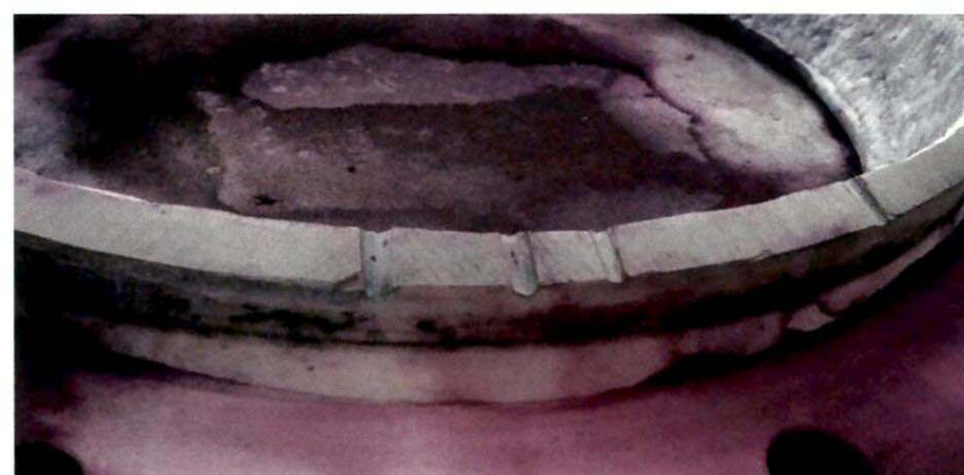
图5 堆焊法兰颈部对接端
