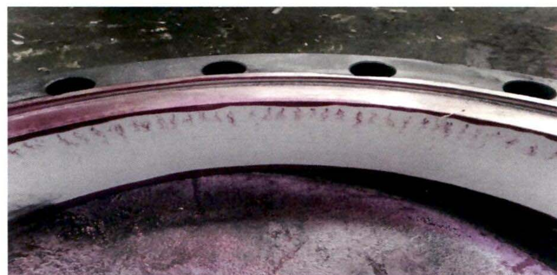
图4 车去堆焊层的法兰内侧
