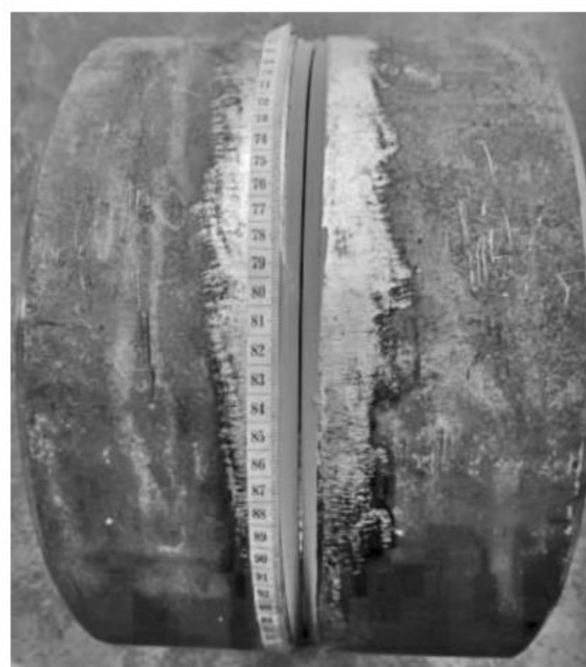
图 3 试件组对及活性剂涂敷图
