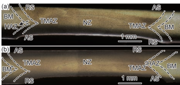
图9 不同下压量焊接接头截面
