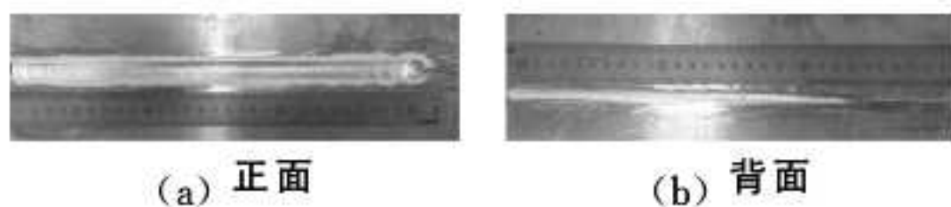
图7 焊接试验工件正反面形貌
