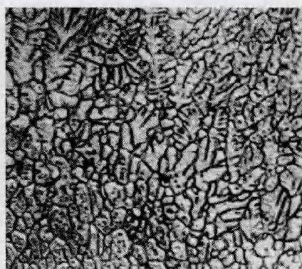
b 随 TIG 焊旋转挤压熔合区显微组织(100×)
