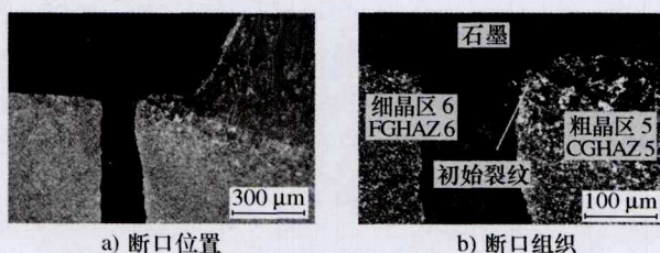
图8 焊缝受拉力样件疲劳断口
