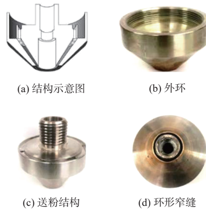
图 1 环状同轴送粉结构
