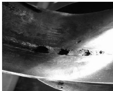
(a) 焊缝中心刺漏
