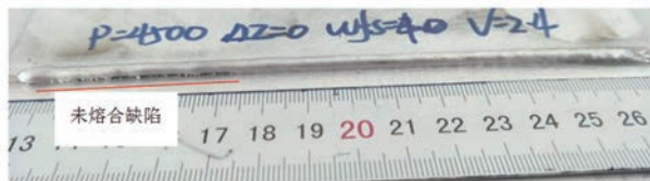
图3 4#未熔合示意图
