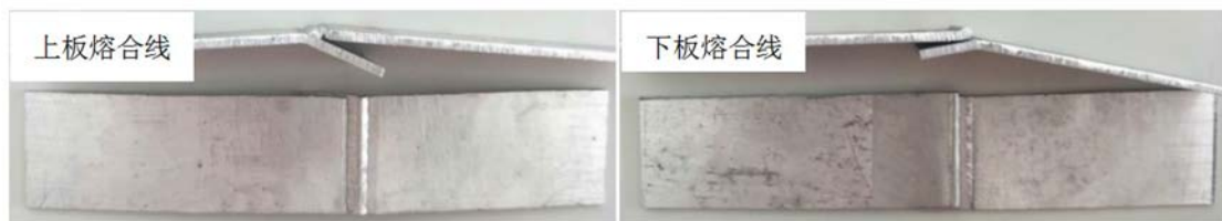
图 7 试样断裂位置
