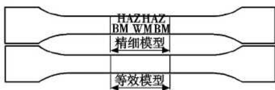
图 1 焊接接头的精细模型与等效模型
