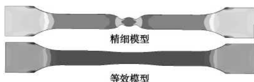
(a) 精细模型与等效模型的 Mises 应力云图
