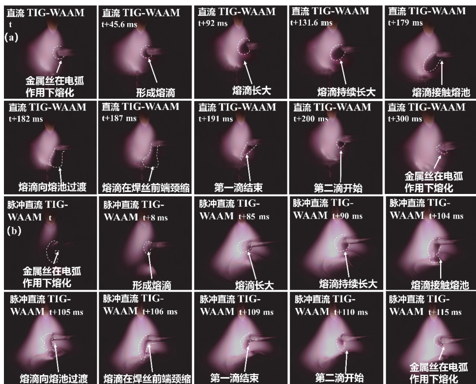
图 8 两种 TIG-WAAM 工艺的电弧和熔滴形貌: (a) 直流沉积; (b) 脉冲直流沉积
