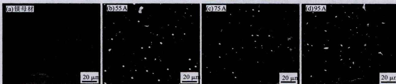
图4 不同焊接电流的镁/钢接头熔焊区微观组织
