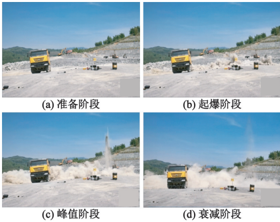
图 13 超临界 CO 2 相变致裂岩石的过程
