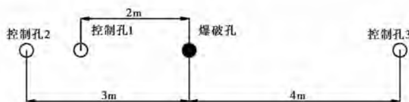
图2 致裂控制爆破钻孔布置
