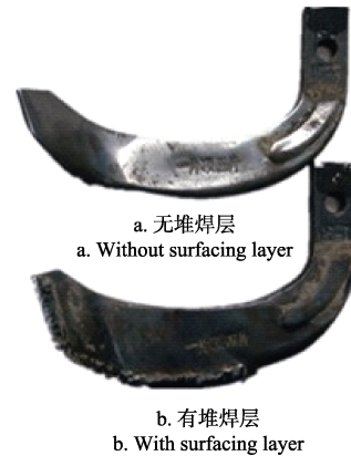
图 9 田间试验后刀具形貌 Fig.9 Blades morphology after field test
