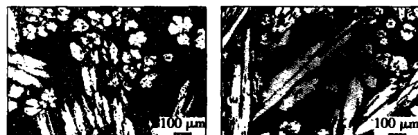
(e) 室温自然冷却堆焊层横截面 (f) 预热自然冷却堆焊层横截面
