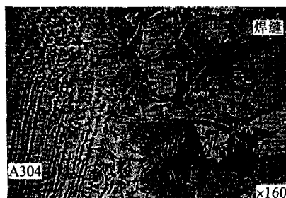
图 5 Inconel 82 焊丝的 A304 侧组织
