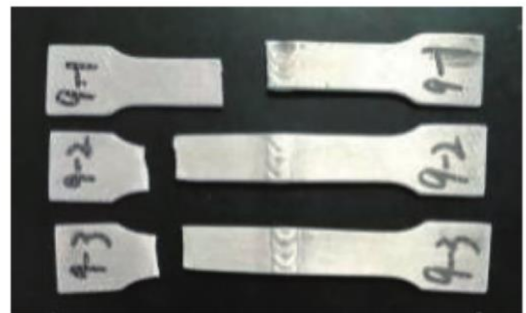
d-电流为60A氩气流量为10L/min
