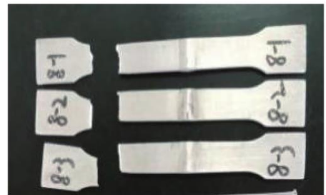
c-电流为60A氩气流量为8.5L/min
