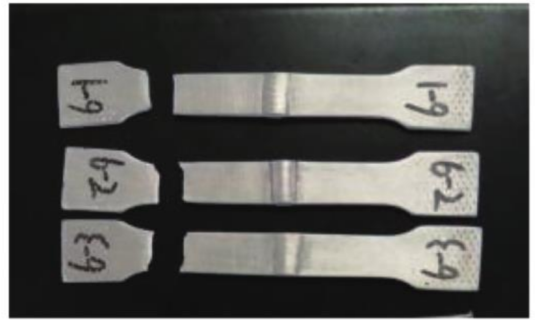
a-电流为55A氩气流量为8.5L/min
