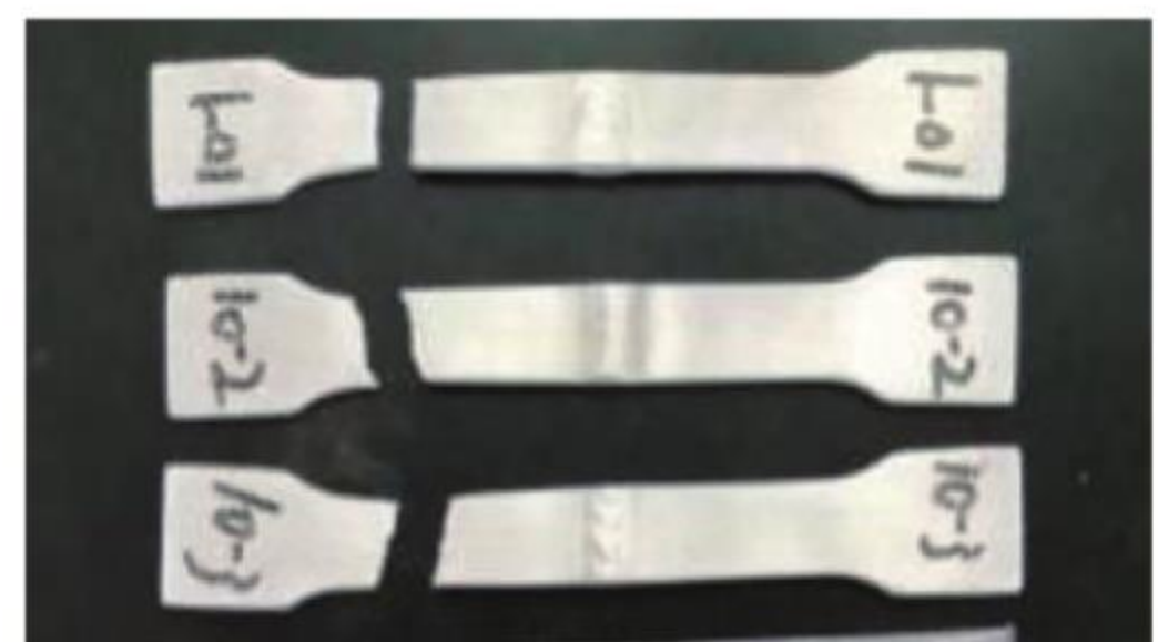
e-电流为65A氩气流量为8.5L/min
