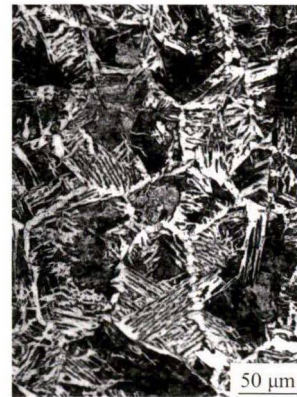
图 7 熔合区微观组织
