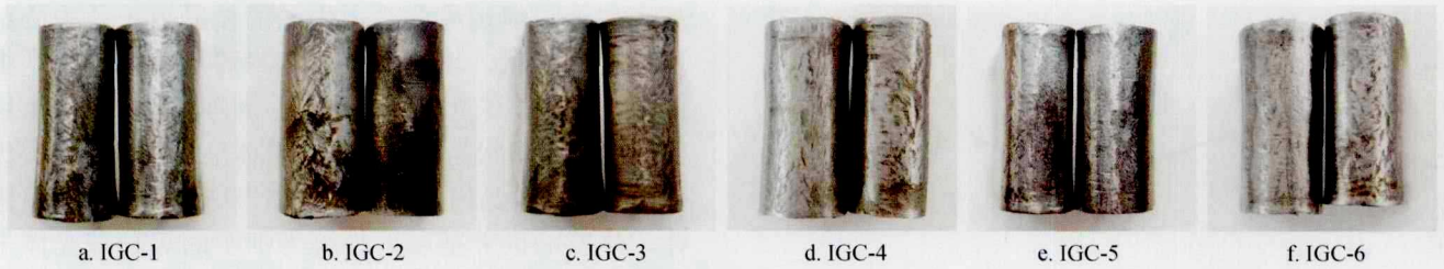
图 6 晶间腐蚀试样试验后的外观图
