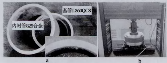
图 7 复合管环端面 and 推出法测试内外管间结合力
