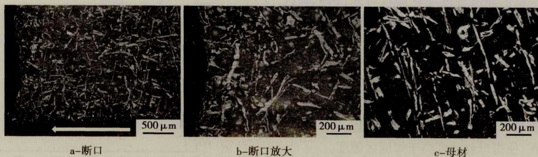
图8 母材拉伸前后微观组织
