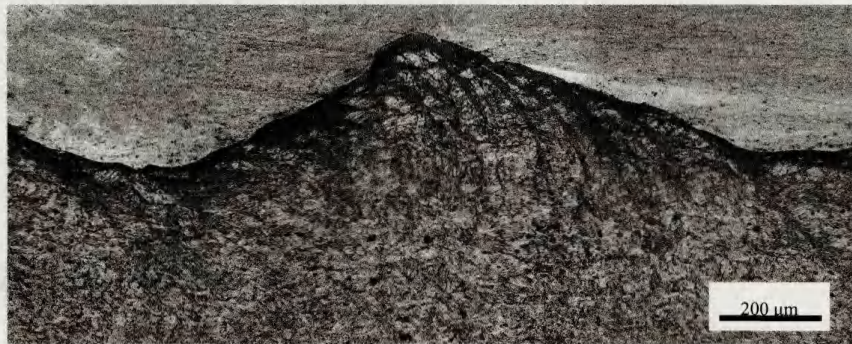
(a) AZ31B/6061 合金复合板连接波状界面的显微组织
