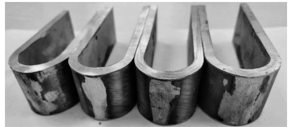
图8 接头弯曲宏观形貌
