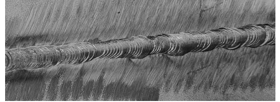
图 2 焊接接头宏观形貌
