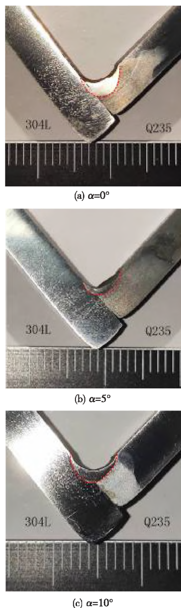
图 13 不同焊枪偏转角度时焊缝融合线
