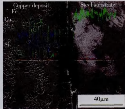
图 6 110A Cu/Fe 界面线扫描结果(焊接电流 110A)
