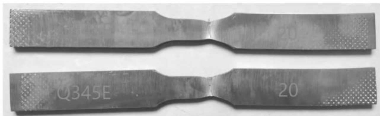
图 2 拉伸试样宏观形貌
