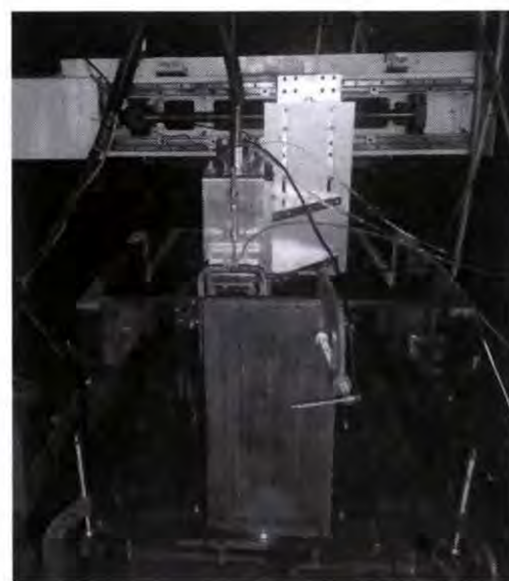
图 2 局部干法水下立焊试验系统实物图
