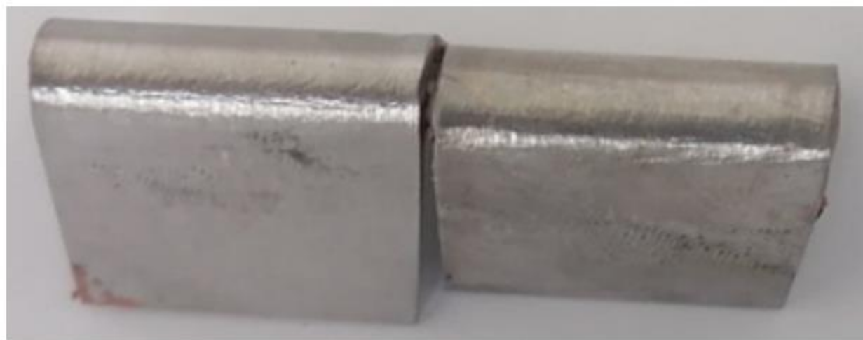
图 10 晶间腐蚀试验结果
