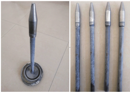
b) 复合棒 Clad bar (TA2/316L)
