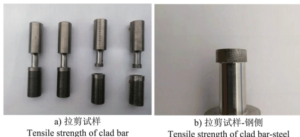
图 5 复合棒拉剪试样
