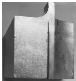
图6 模拟试件宏观检查情况
