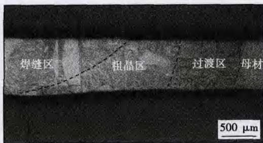
图2 TIG焊接头组织形貌( I=40\text{ A} )
