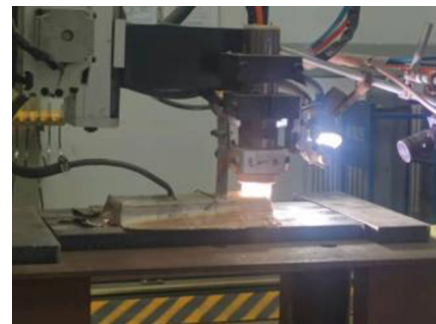
图 2 K-TIG 焊接系统 Fig.2 K-TIG welding system
