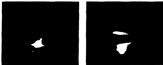
图5 变焦镜头、高压焊接电弧 (0.2 MPa, 0.6 MPa)
