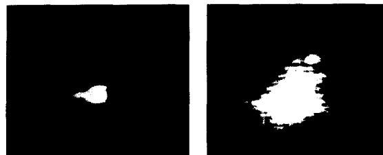
图4 定焦镜头、高压焊接电弧 (0.2 MPa, 0.6 MPa)
