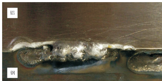
图2 铝/钢焊缝成形图
