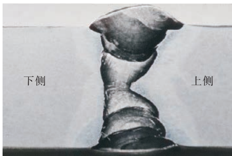
图6 焊接接头宏观形貌
