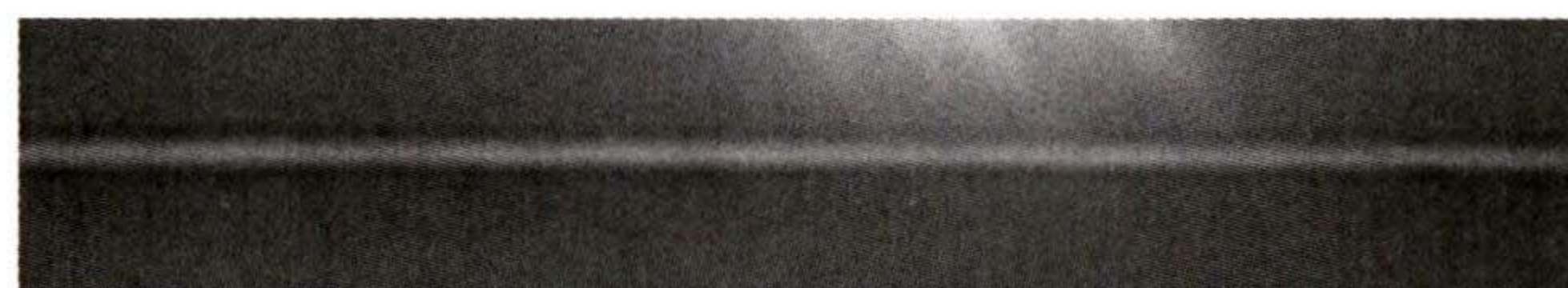
图 3 焊缝射线探伤结果
