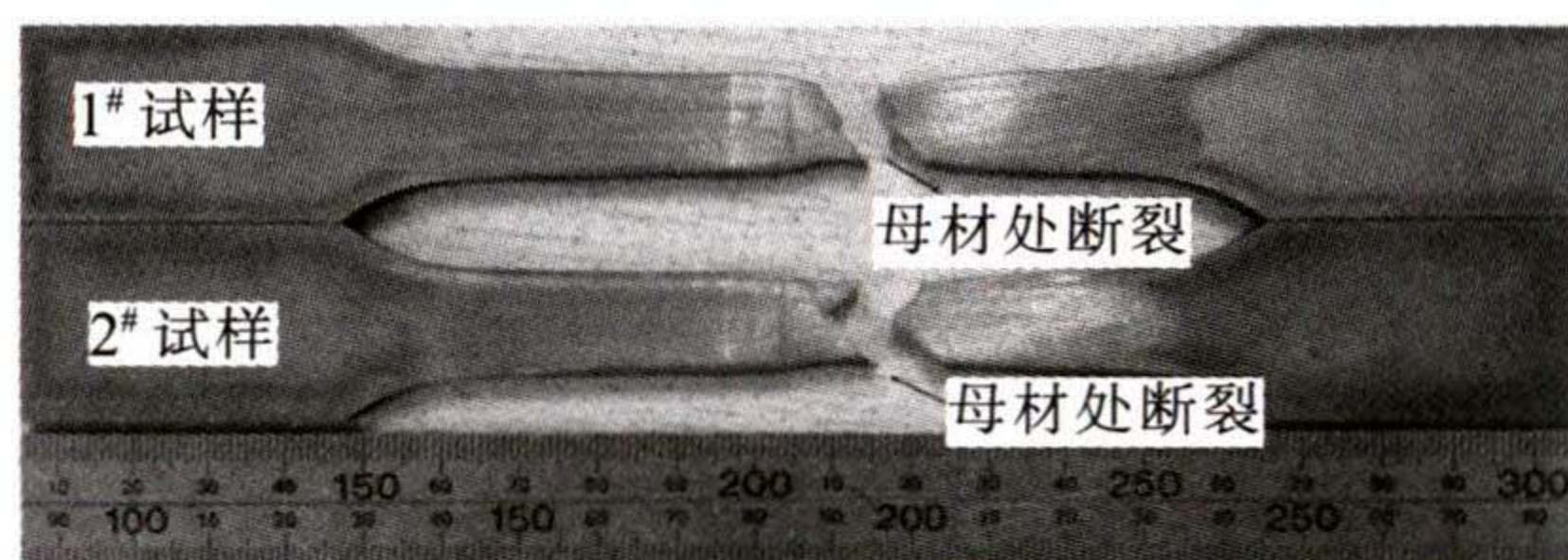
图 9 拉伸后试样的形貌
