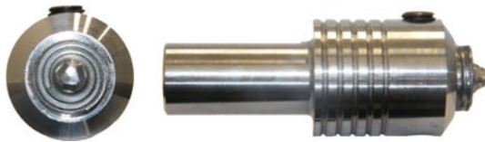
图 1 搅拌工具照片 Fig. 1 Macro morphology of stir tool.
