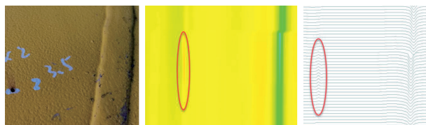
a. \phi 1016 mm 管道上 \phi 2 mm 穿孔缺陷实物及检测数据云图和通道曲线图
