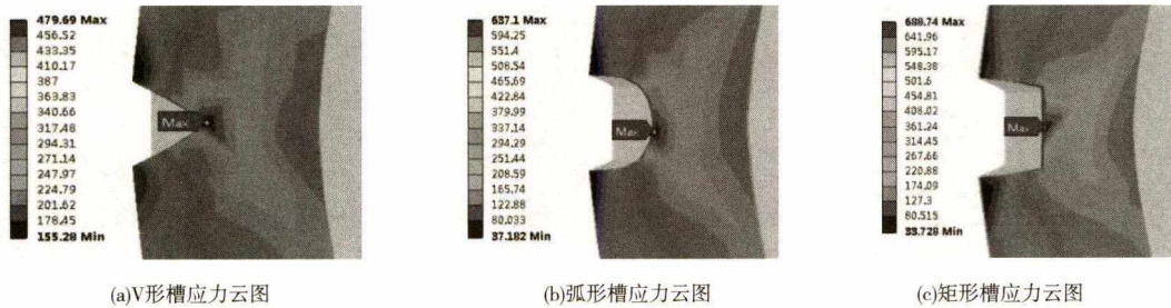
图7 不同槽形状下的断面应力云图
