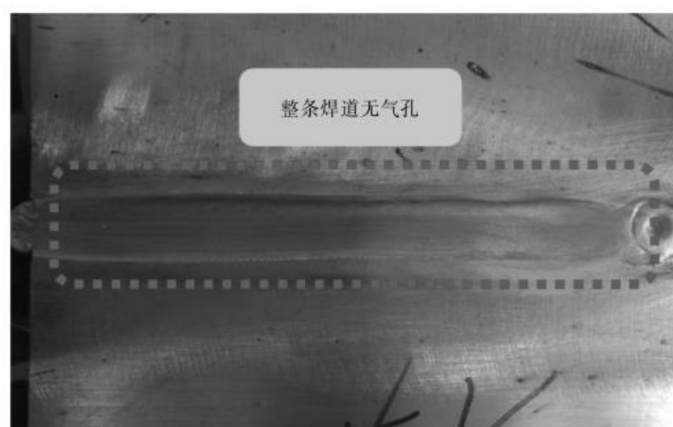
图 8 500GP5 加装 \Phi 1.2 mm 孔径节流阀时, 10 mm 平对接焊接效果
