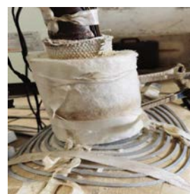
图3 加热小管和加热大管用的感应加热器
