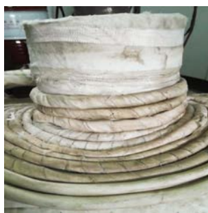
图4 管座缠绕线圈后的实物照片
