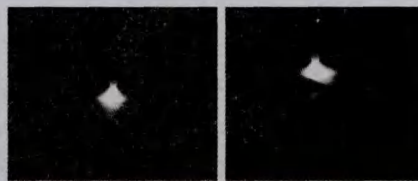
图7 间隙 X=0 在活性剂 \text{SiO}_2 作用下焊接电弧偏移
