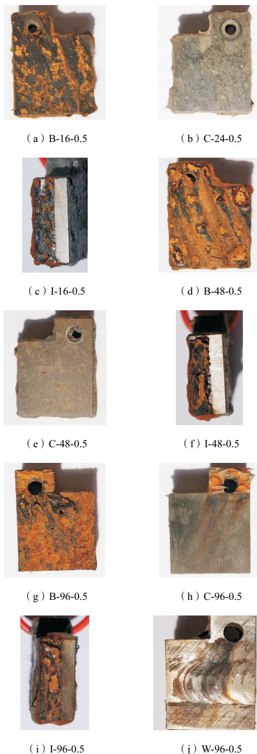
图 7 试件在不同试验时长下除锈前的宏观形貌
