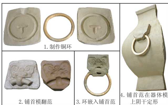
图一二 后铸法模拟实验流程
