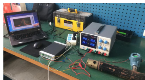
图 2 泄放压力测试系统设备连接
