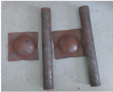
图3 隔板试验Ⅱ测试结果
